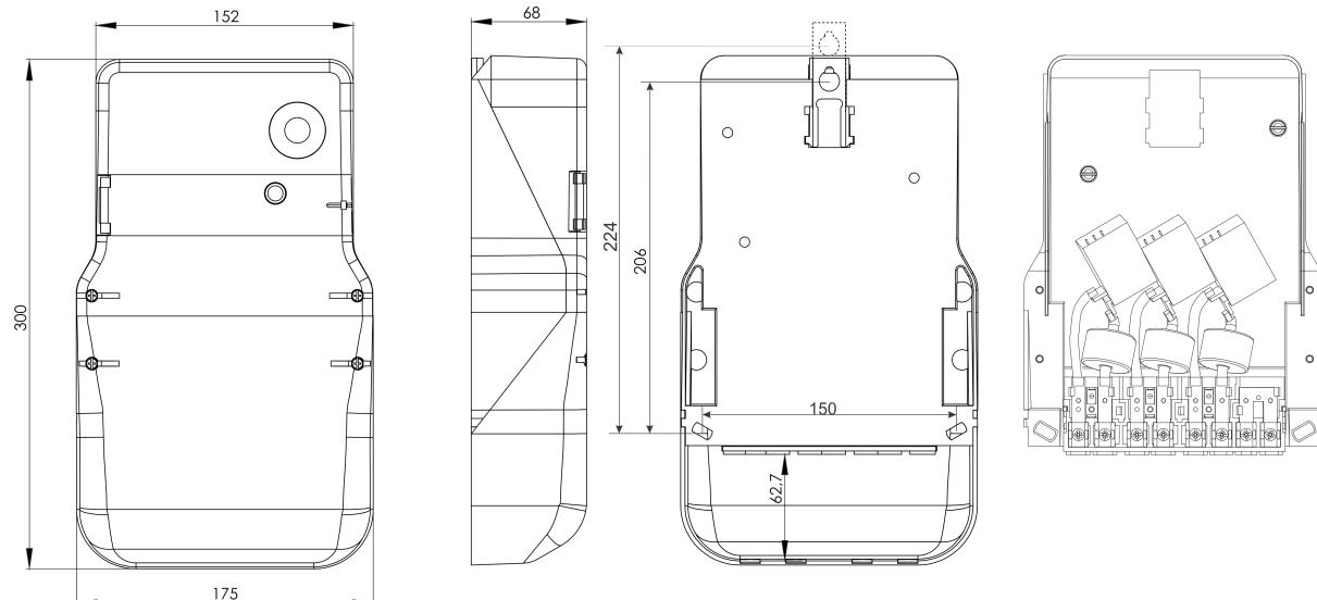
Slika 4. Dimenzijske brojila u kućištu B3 sa internom sklopkom i modemom
