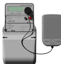
Slika 12. Komunikacija brojila i ručnog terminala upotrebom IC sonde
