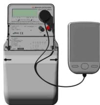
Slika 15. Komunikacija brojila i ručnog terminala upotrebom IC sonde
