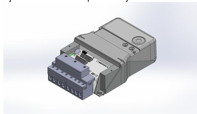
Slika 11. Način postavljanja bistabilne sklopke na brojilo
