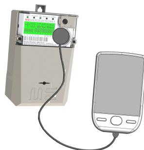
Slika 14. Komunikacija brojila i ručnog terminala upotrebotom IC sonde
